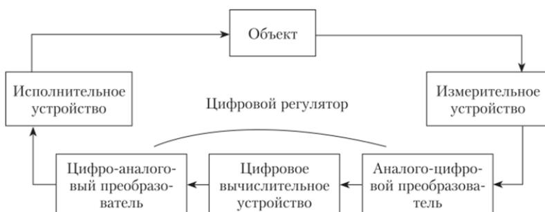
**Рис. 6.25. Структурная схема системы автоматического управления с цифровым вычислительным устройством**
