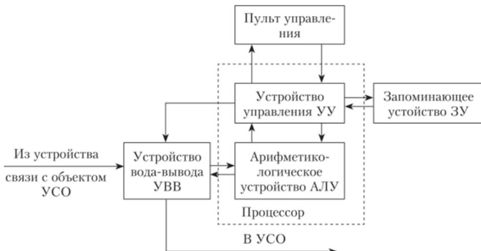
**Рис. 6.22. Укрупненная структура ЭВМ**
