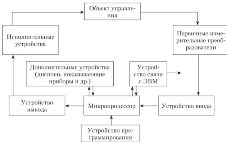
**Рис. 6.24. Структура системы управления с программируемым контроллером**
