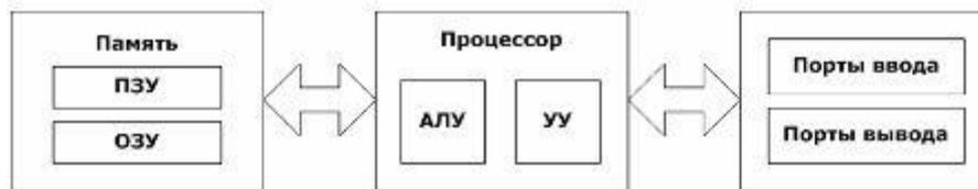
Рисунок 1 – Структура микропроцессорной системы
