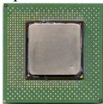
Рисунок 2 – Внешний вид микропроцессора Intel Pentium 4
