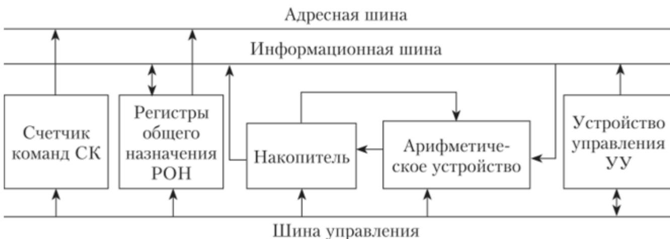
**Рис. 6.23. Структура микропроцессора**
