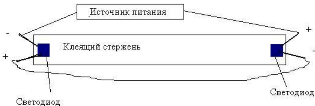
Схема подключения подобия неоновой лампы.
