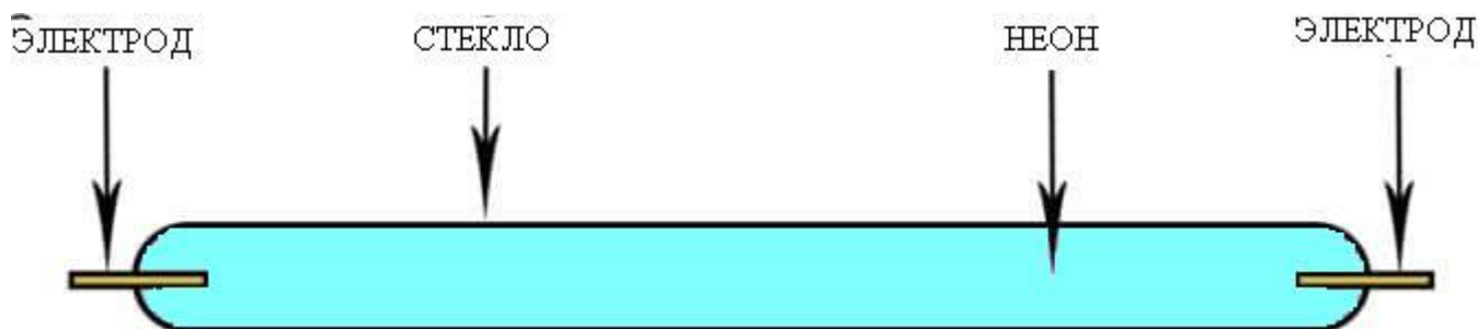
Конструкция неоновой лампы
