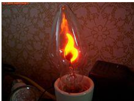
Декоративная неоновая лампа, электроды покрыты люминофором
