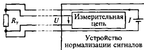
Рис. 4.25. Подключение датчика четырехпроводной линией
