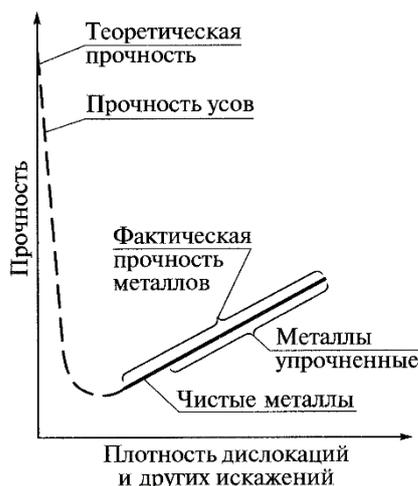
Рис. 2.8. Зависимость прочности металла от искажений кристаллической решетки
