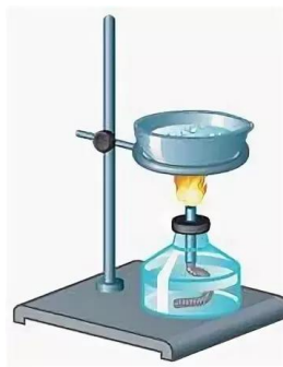
Рисунок 15 - Установка для выпаривания жидкости
